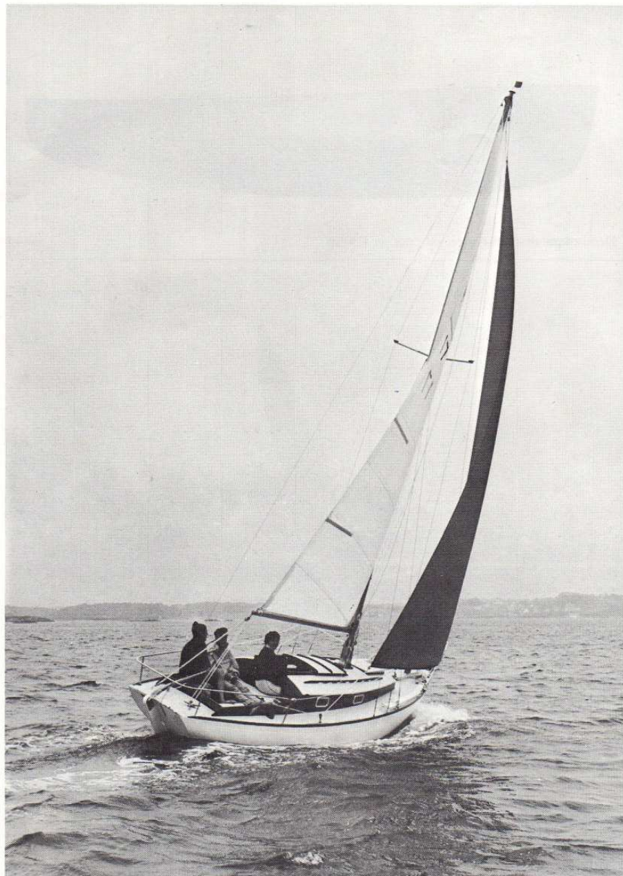
Un joli sloop à tableau classique, le Dauphin. Le gréement est simple et efficace, gènois en tête de mât, grand'voile de bonne surface pour les manœuvres de port, un étai de barres de flèche, deux bas-haubans et un étai arrière.
