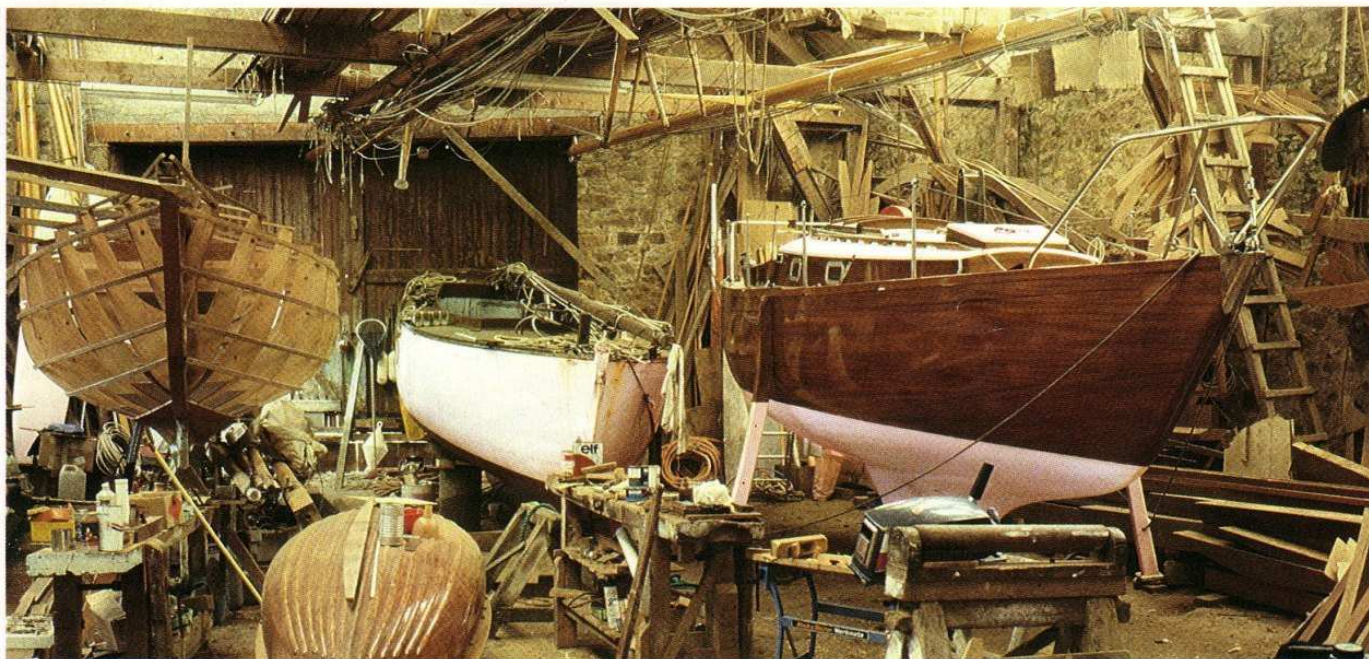
Un spectacle merveilleux, que peu de citadins ont l'occasion de contempler : l'intérieur d'un chantier traditionnel en activité. A gauche, les gabarits d'un futur J.25, au fond, un superbe cotre de Carantec en restauration, à droite, Reder Noz , le bateau de Georges Jézéquel.
