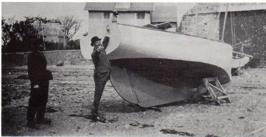
Un « Carantec » d'avant-guerre bien caractéristique devant les chantiers Moguéro. Aiguillonnés par la compétition, les constructeurs de la baie de Morlaix ont mis au point un type de bateau rapide et marin, adapté aussi bien à la pêche côtière qu'à la plaisance. Remarquer la petite voûte plate terminée par un tableau vertical, l'étrave droite, la quille profonde en sifflet ; lancée en 1930 pour Monsieur Coste, l' Yvonne n'a pas de retour de galbord.
