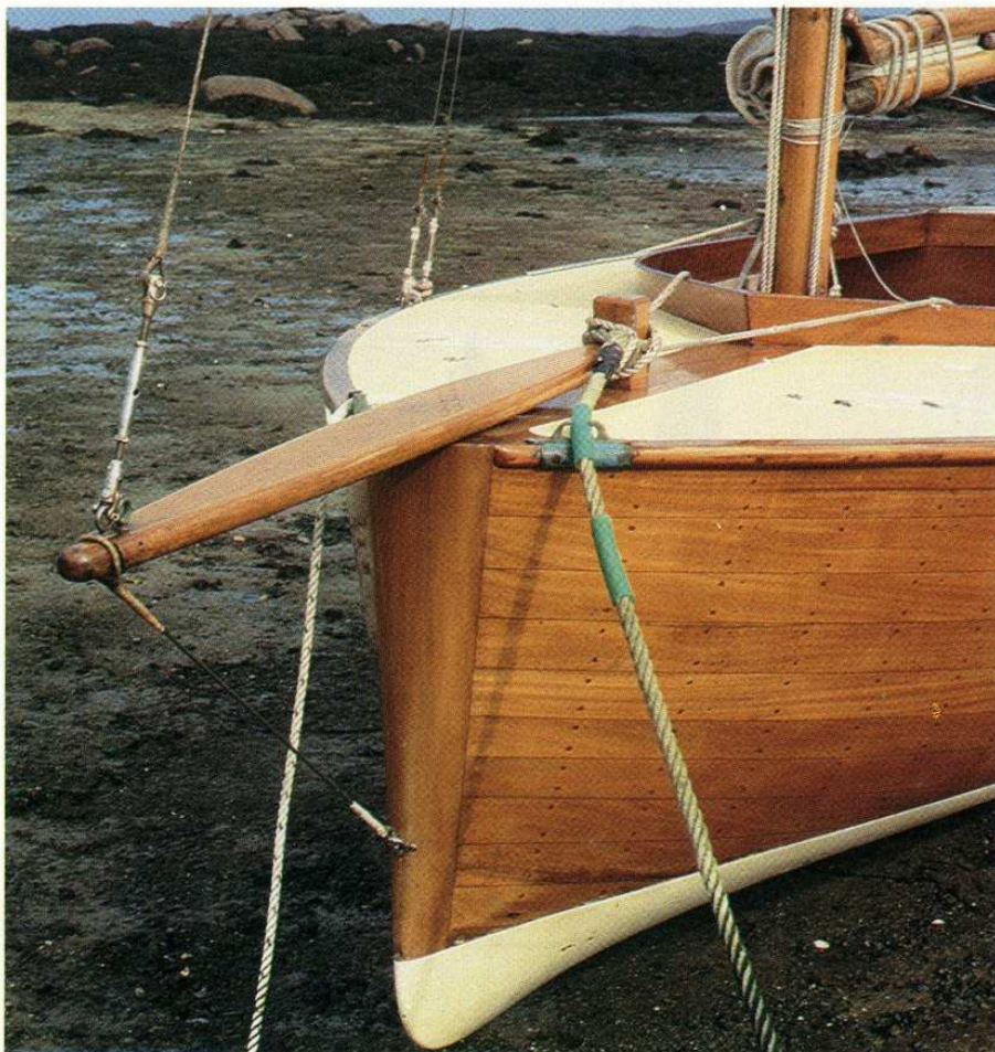
L'exceptionnelle qualité de la construction Jézéquel est bien en évidence sur ce cliché. Précision des ajustages, choix des tons de bois, beauté des vernis ; pour le propriétaire de Mor Vran , un des plus jolis Cormorans de la baie de Morlaix, chaque retrouvaille avec son bateau est un instant de plaisir neuf. Un bonheur esthétique partagé par tous les traîneurs de grève de Carantec...
