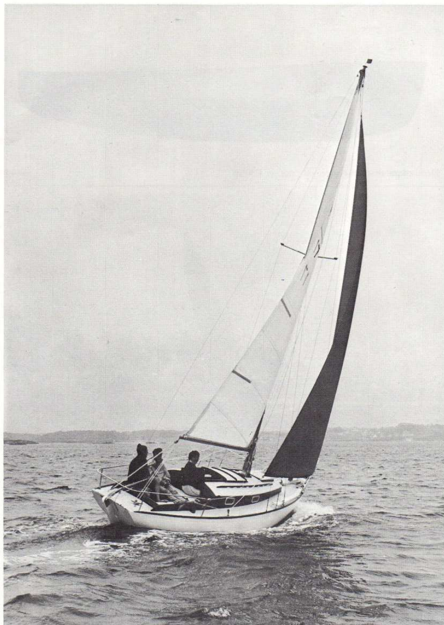
Un joli sloop à tableau classique, le Dauphin. Le gréement est simple et efficace, gènois en tête de mât, grand'voile de bonne surface pour les manœuvres de port, un étage de barres de flèche, deux bas-haubans et un étai arrière.
