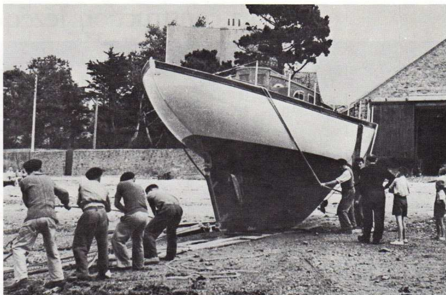
Lancement du Dieu me garde , un grand ketch de croisière sur plans Cornu (1950). Chez Jézéquel, toutes les mises à l'eau se font avec des moyens réduits à l'essentiel : un chemin de planches, quelques « roules » métalliques, des bras solides... et beaucoup de doigté.
