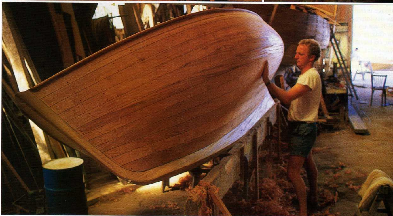
Construction et restauration de Cat-boats au chantier Jézéquel en 1992. A gauche : bordé et barrotage de Chatouille , à Vincent Besnier, dont l'étrave rentrante est inspirée par les cat-boats américains de Cape Cod. En haut à droite : arrière de Carve an Ty , une unité ancienne qui possède encore un gouvernail dont l'axe traverse la voûte par une jaumière. Au milieu à droite, tableau de Foucade , à Jean-Louis Monsauge. Ci-dessus : ponçage de Foucade .
