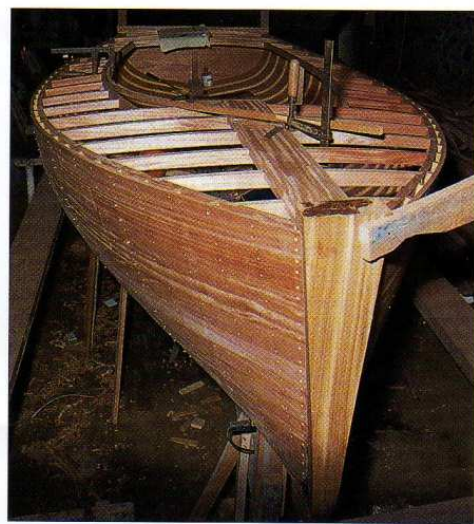
La qualité des assemblages – ici, l'étrave large au premier plan – caractérise les Cormoran construits par le chantier Jézéquel.
