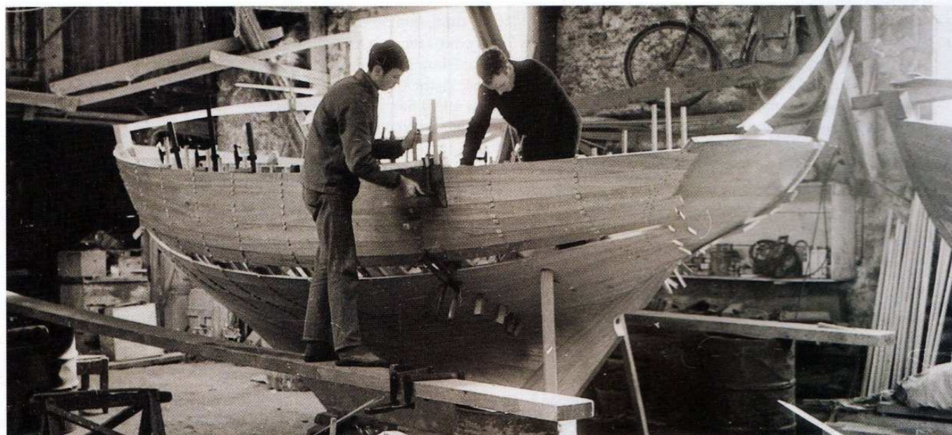
Un Dauphin en construction au chantier Jézéquel. Avant la mise en place des membrures ployées rivetées cuivre, des clous maintiennent les bordages aux gabarits, un tasseau protégeant l'acajou de la tête de la pointe.
