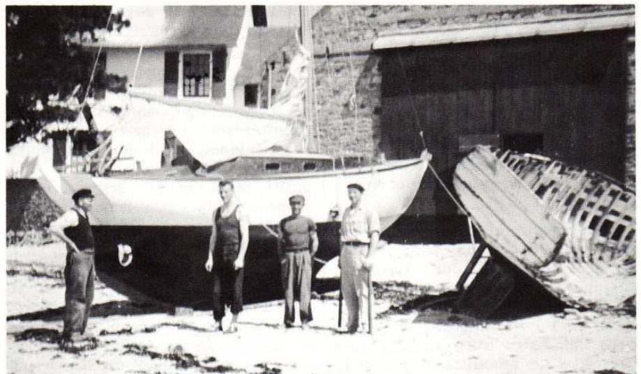
Image symbolique d'une époque de transition : à droite, la carcasse d'un cotre de Carantec, très représentatif du type traditionnel local ; à gauche, un 7 m 50 Sergent flambant neuf, du genre des jolis petits sloops marconi à tableau qui feront la plaisance classique d'après-guerre en Bretagne.
